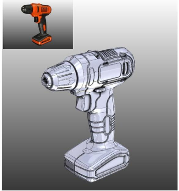
新規金型を起す際には費用や時間がかかるため、既存製品の形状を3Dデータで取得し、部分的にCAD化していくことで金型製作コストを抑えて開発することが可能です。
